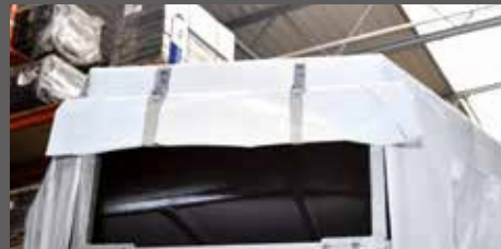
Mit zwei Hochrollriemen fixierbare Plane an der Stirnwand (Sonderzubehör auf Anfrage)
