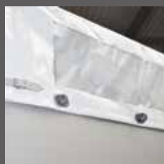
Weißer Plane leicht bedienbar durch Drehverschlüsse
