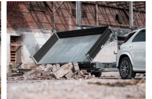
Der HTK kann mit wenigen Handgriffen rückwärts und seitlich abkippen.
