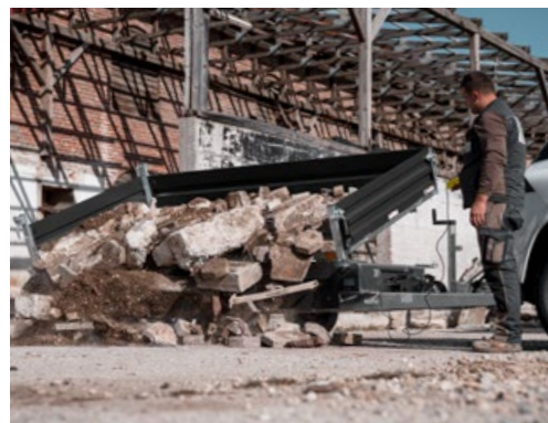
Aluminiumbohlen dürfen nur in Verbindung mit einer Heckabstützung verwendet werden.
