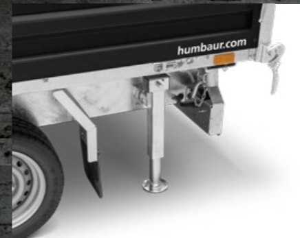
TELESKOP-KURBELSTÜTZEN Optimale Standfestigkeit, abklappbar
