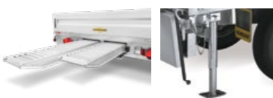
Aluminiumbohlen dürfen nur in Verbindung mit einer Heckabstützung verwendet werden.
