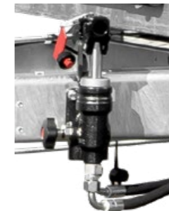
E-Pumpe und Nothandpumpe
