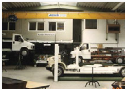
Montage des selbst entwickelten Zentralrohrchassis 1986
